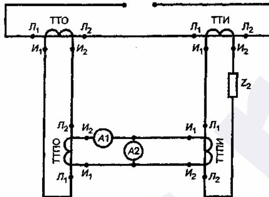
ТТО — образцовый трансформатор тока; ТТИ — испытуемый трансформатор тока;
